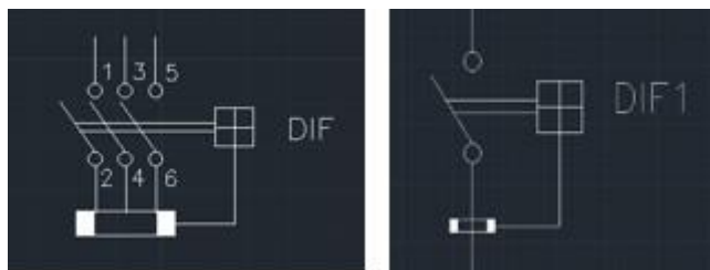
Ilustración 107: Esquema unifilar relé diferencial automático.
