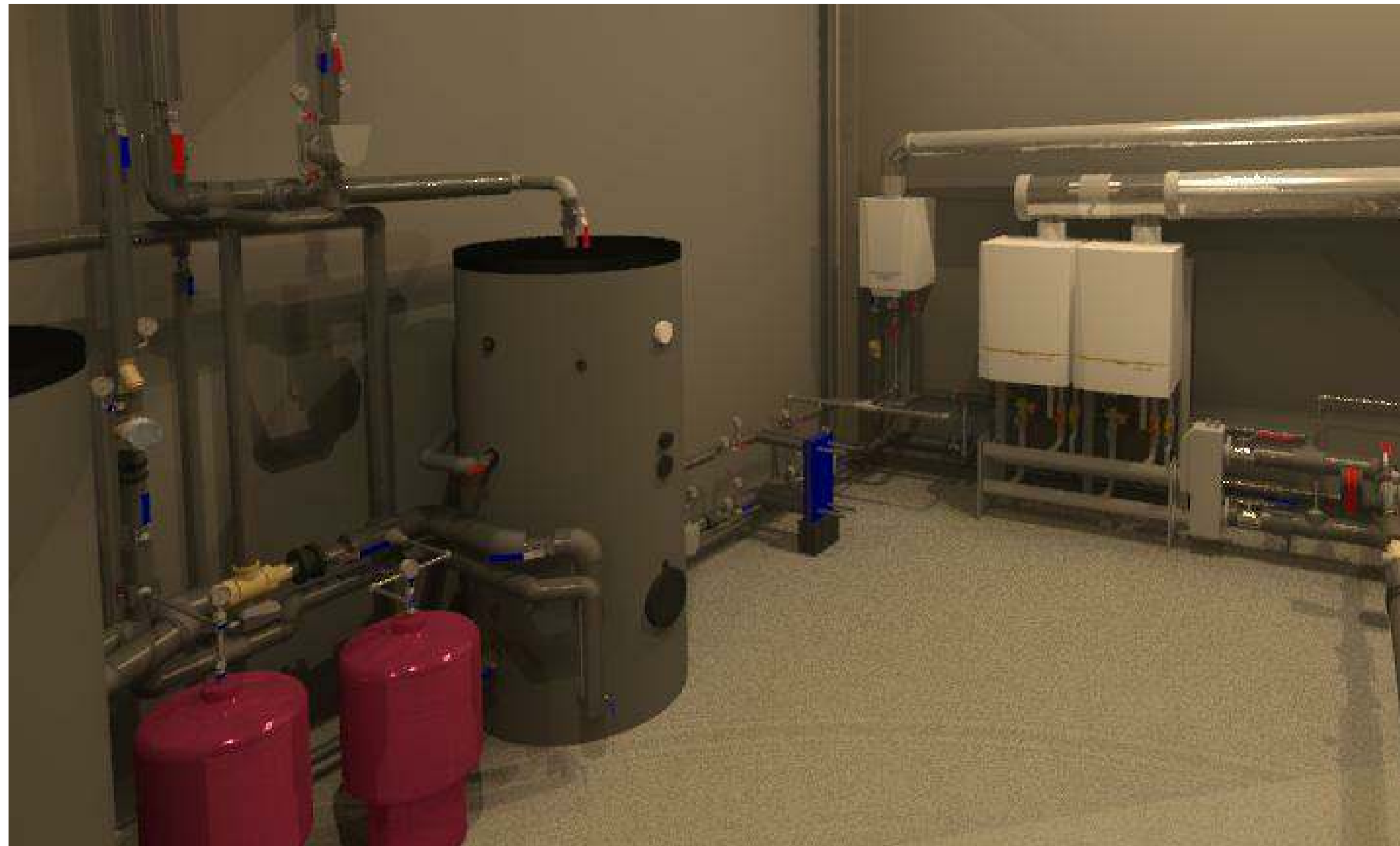
DETALLES SALA DE INSTALACIONES CON CALDERAS, DEPÓSITOS Y RECUPERADORES RENDERIZADAS
