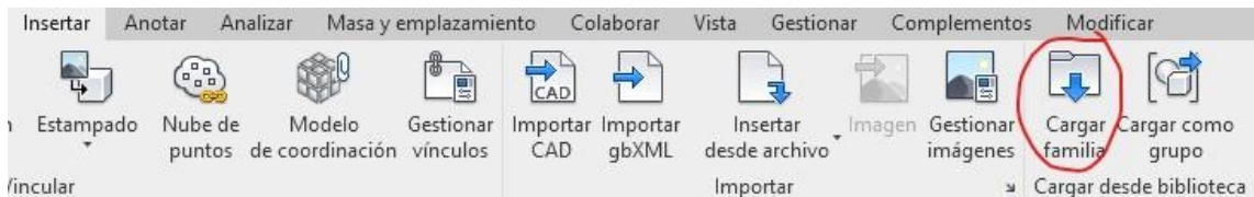
Ilustración 5: Forma de introducir puertas, mobiliario, aparatos sanitarios...
