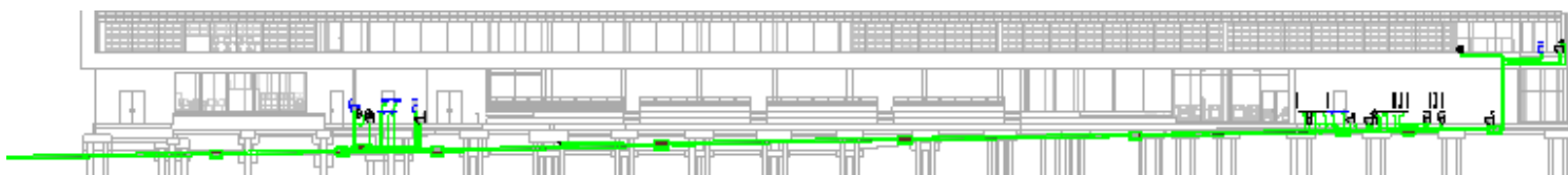
Ilustración 54: Visualización alzado circuito de saneamiento con pendiente.
