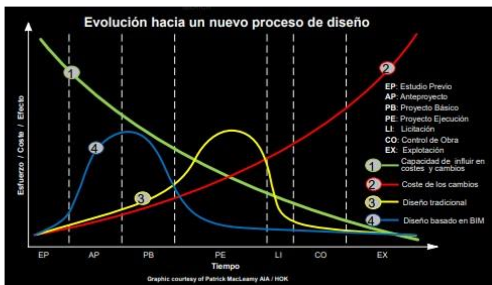
Ilustración 4: Curva de esfuerzo del proceso constructivo (Fuente: Patrick MacLeamy).
