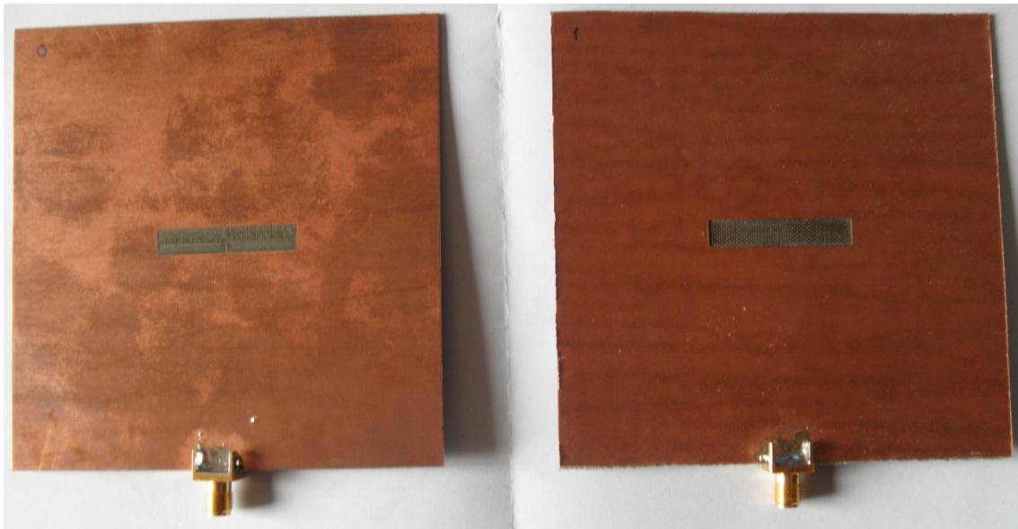
Figura 42: Antenas slot 3GHz fabricadas
