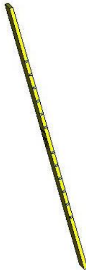
Figura 58: Slot con varias corrugaciones rectangulares
