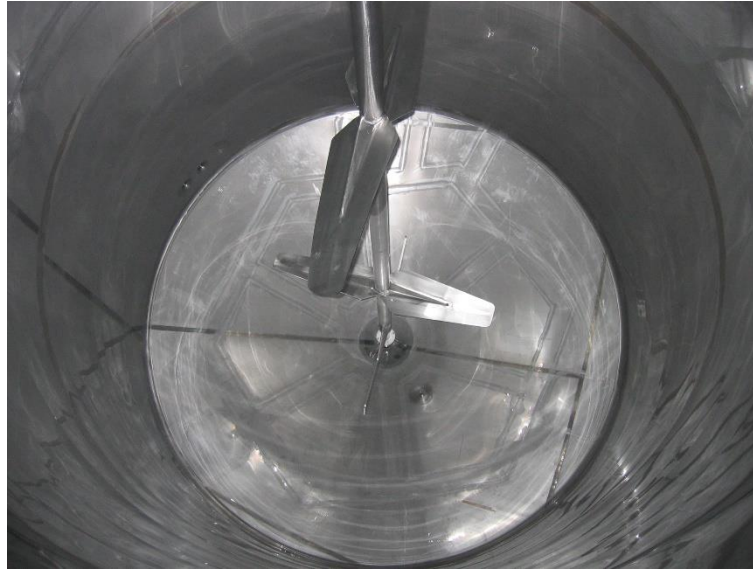
Figura 19. Agitador de palas dentro de un depósito.
