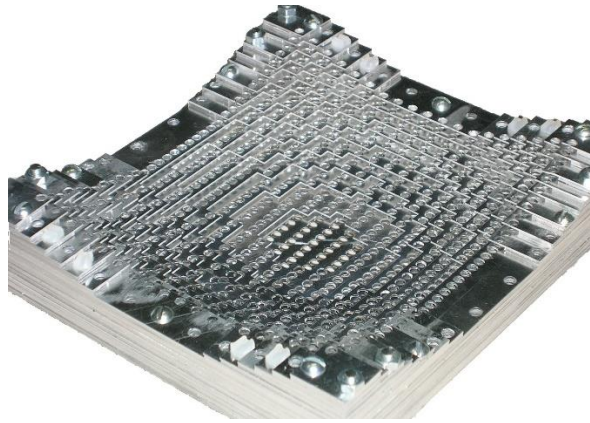
Figura 5: Lente realizada con metamateriales, en la UPNA
