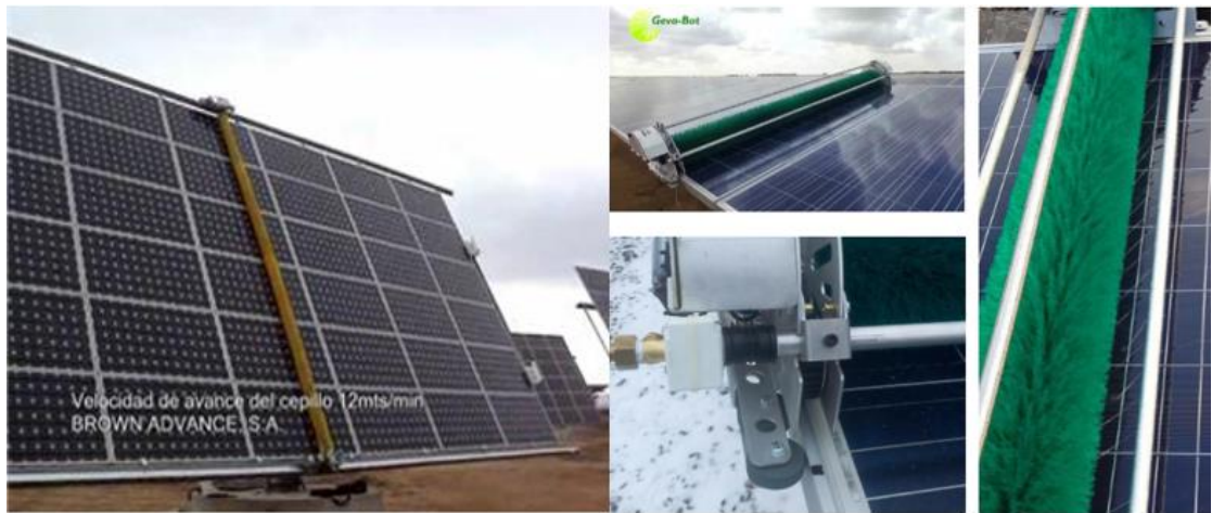
Figura 49. Proceso de limpieza mediante cepillos automáticos o guiados horizontalmente (izquierda [40] y derecha [42])
