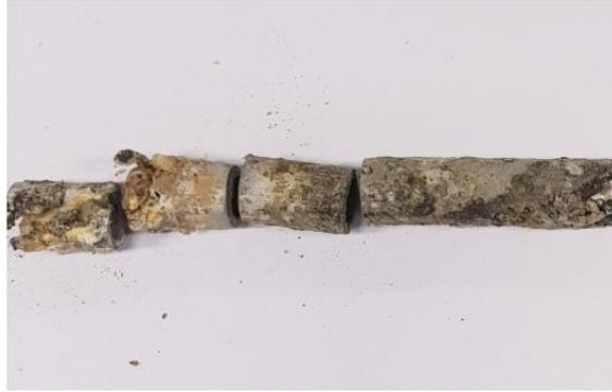
Figura 5.28 Probeta de aluminio anodizado fracturada
