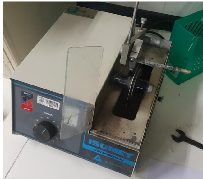
*Figura 4.6 Cortadora metalográfica Isomet de baja velocidad*
