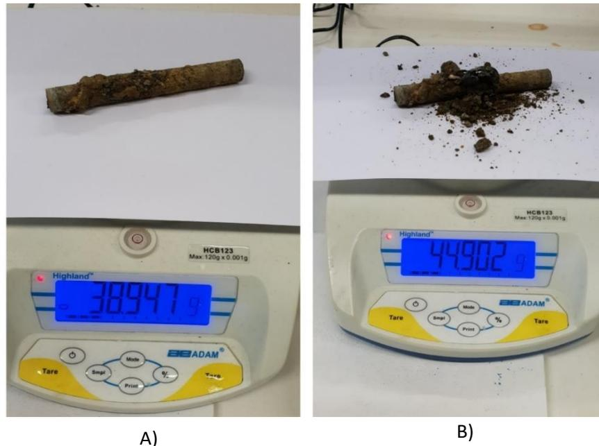
Figura 4.5 Determinación del peso de la probeta a) Sin tierras b) con tierras
