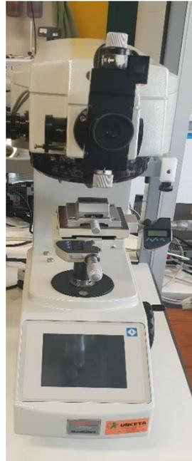
*Figura 4.26 Microdurómetro Vickers empleado en el análisis de microdurezas*
