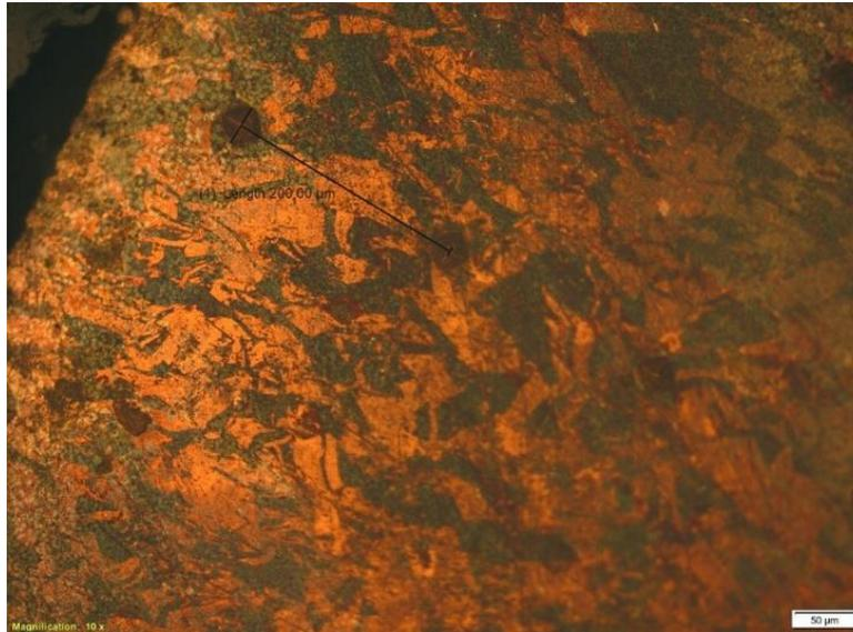
*Figura 4.28 Distancia entre huellas realizadas por el durómetro*
