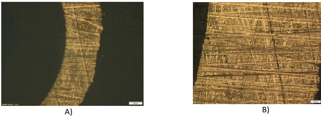
Figura 4.20 Acero galvanizado tras etapa 1 de pulido. A) x25. B) x100
