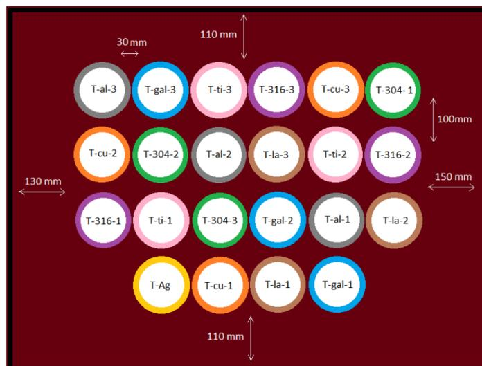
Figura 4.3 Disposición de las muestras en la cámara Kesternich [17]
