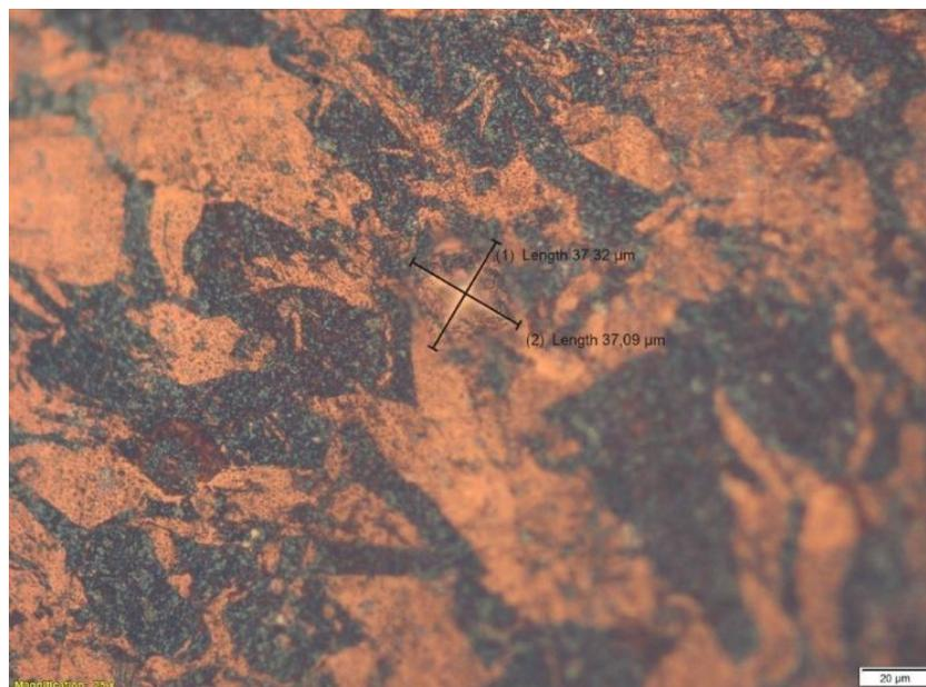
*Figura 4.29 Medición de diagonales de la huella realizada por el durómetro*
