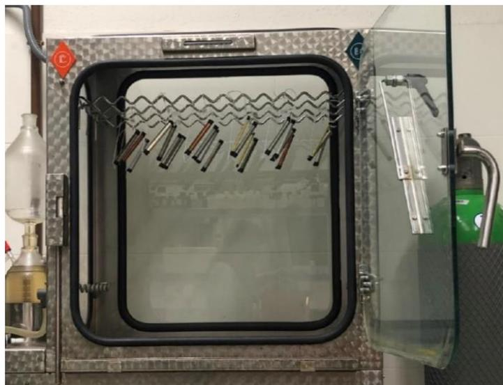
Figura 4.2 Muestras colocadas en el interior de la cámara Kesternich [17]
