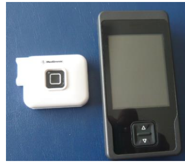
estimulador externo para la fase de prueba (estimulación temporal)
