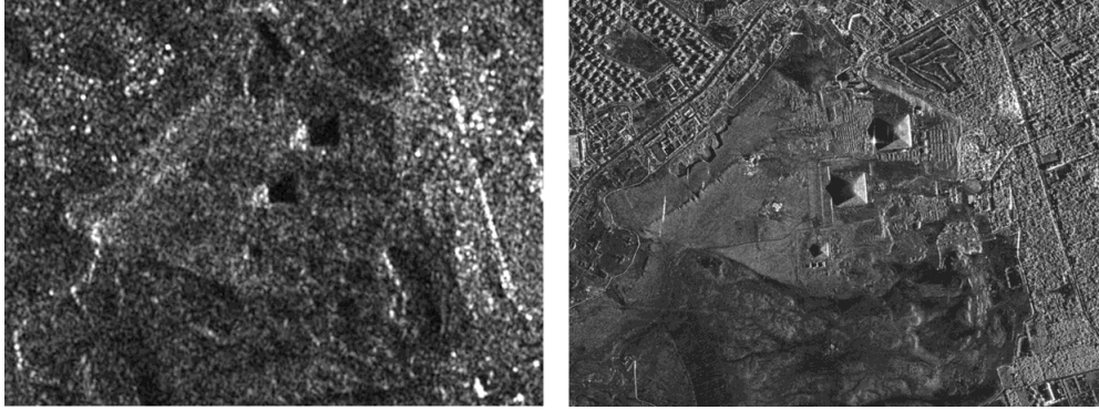
Figura 7: Comparación de la resolución espacial en imágenes SAR. (izq.) Imagen de baja resolución: píxel de 20x20 metros. (drcha.) Imagen de alta resolución: píxel de 1x1 metros [14].
