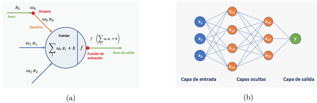
Figura 13: (a) Neurona individual, elemento básico de las redes neuronales. (b) Red neuronal totalmente conectada, compuesta de neuronas agregadas en capas.
