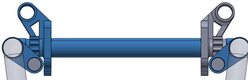
Ilustración 17: Vista frontal del Prototipo 3 de balancín montado en el armazón inferior de la silla de ruedas.
