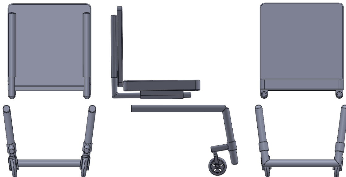
Ilustración 9: Vistas en perfil y alzado del primer modelo de la silla de ruedas.
