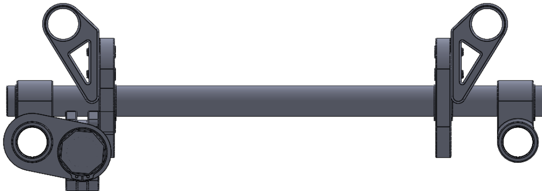
Ilustración 36: Vista frontal del sistema de balancín.
