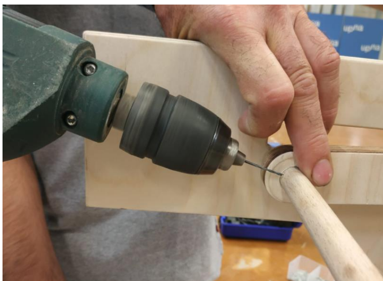
Ilustración 92: Imagen realizando el agujero por el que irá el pasador que fijará las arandelas a los brazos.
