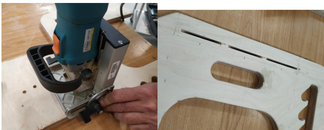
Ilustración 82: Fresadora de galletas y ranuras realizadas.
