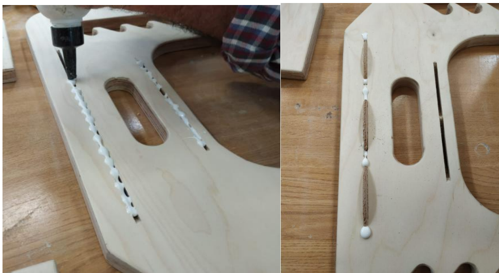
Ilustración 83: Colocación de cola blanca y posteriormente las galletas de madera.
