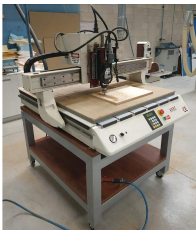
Ilustración 76: Imagen de la fresadora mecanizando piezas.
