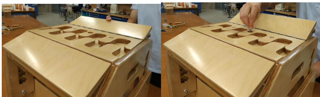
Ilustración 71: Regulación a la posición deseada y colocación del pasador.
