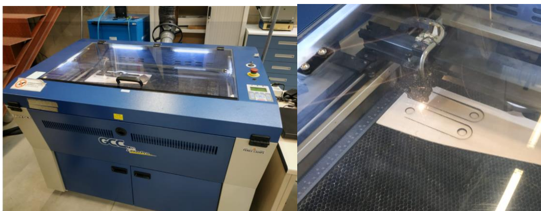
Ilustración 88: Imágenes de la máquina utilizada para realizar los cortes por láser y la máquina realizando los cortes.
