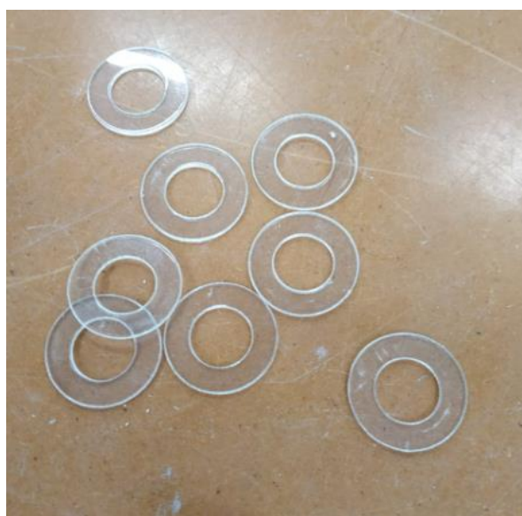
Ilustración 90: Arandelas transparentes realizadas mediante corte por láser.
