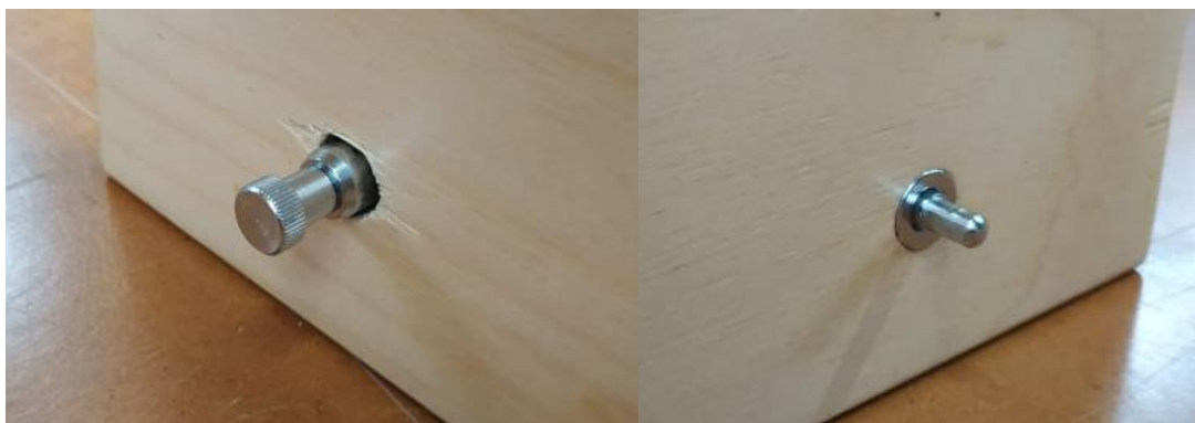
Ilustración 95: Imagen del pasador con muelle fijado en la madera visto desde los dos lados.
