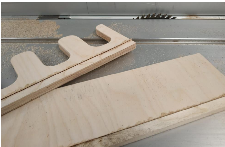
Ilustración 80: Corte realizado para la colocación de las bisagras de piano.
