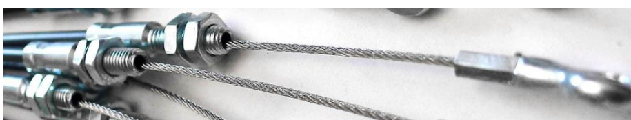
Ilustración 25: Imagen de varias transmisiones de cable mecánico. [30]
