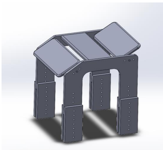
Ilustración 49 :Imagen del segundo prototipo, se sustituye la silla por un taburete.
