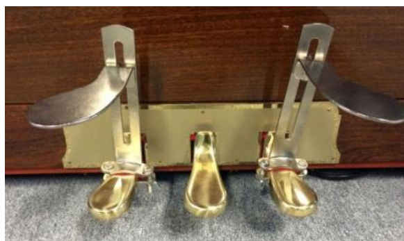
Ilustración 4: Mecanismo de extensión de los pedales para niños sencillo.
