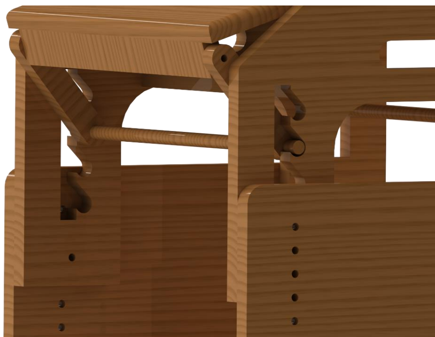
Ilustración 57: Regulación inclinación parte delantera.
