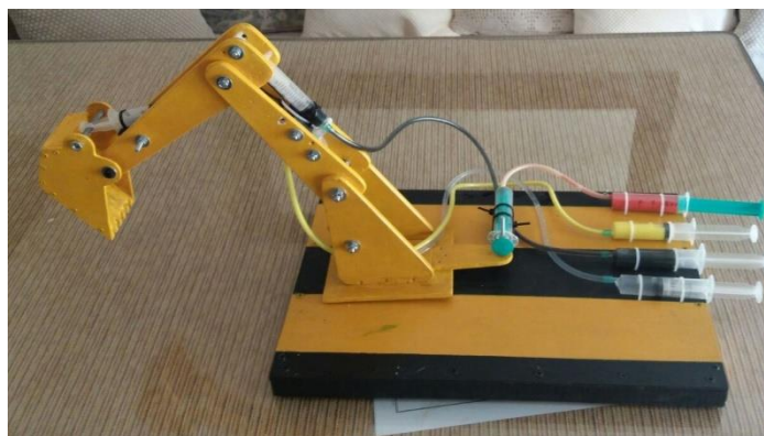
Ilustración 21: Imagen de brazo hidráulico casero en el que se puede apreciar el funcionamiento que se busca en el proyecto. [31]
