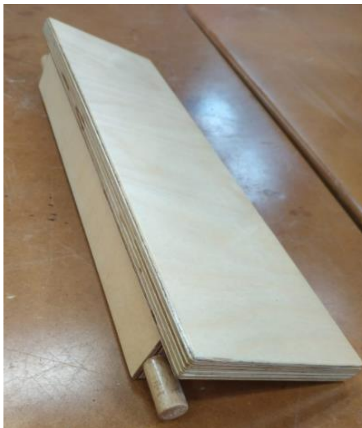
Ilustración 85: Imagen del listón de madera unido a la tabla reclinable trasera. También se ve el trozo de barra que va incrustado en el listón.
