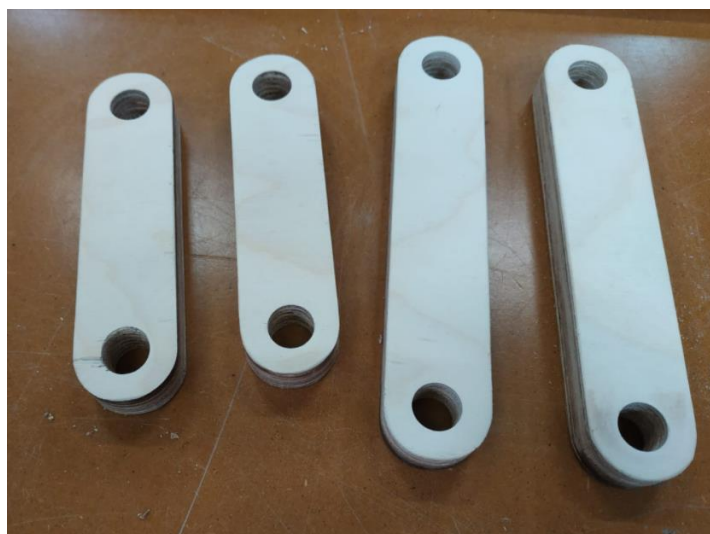
Ilustración 89: Brazos de madera definitivos utilizados para la regulación de la inclinación de las tablas del asiento.
