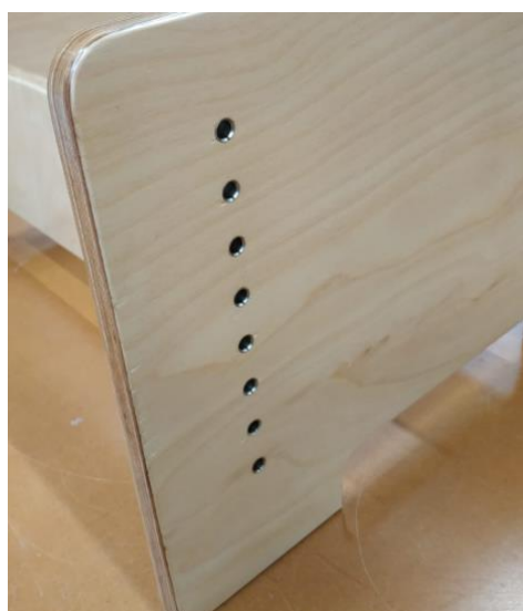
Ilustración 67: Cilindros de acero en los agujeros de la madera.
