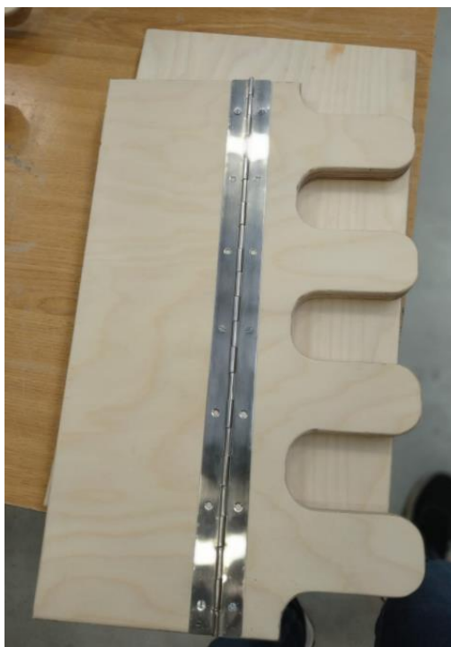
Ilustración 81: Unión de la tabla reclinable delantera mediante la bisagra piano.
