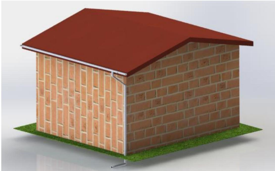
Ilustración 19. Modelización 3D de desconexión de bajantes de tejados en SolidWorks 2020
