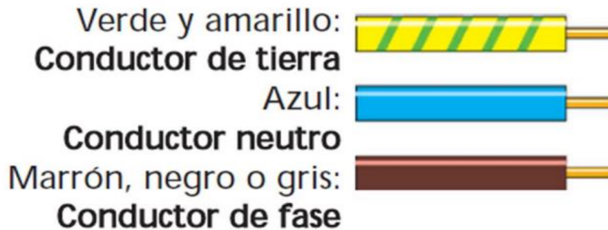
Ilustración 7: Código de colores de cables
