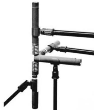
Figura 8.2 – Configuración de grabación 3D FOA
