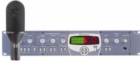
Figura 11 - Micrófono Soundfield TSL que realiza la conversión de A-format a B-format
