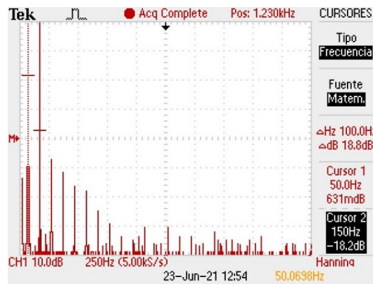
Ilustración 65: Prueba experimental 4: FFT de la tensión de red
