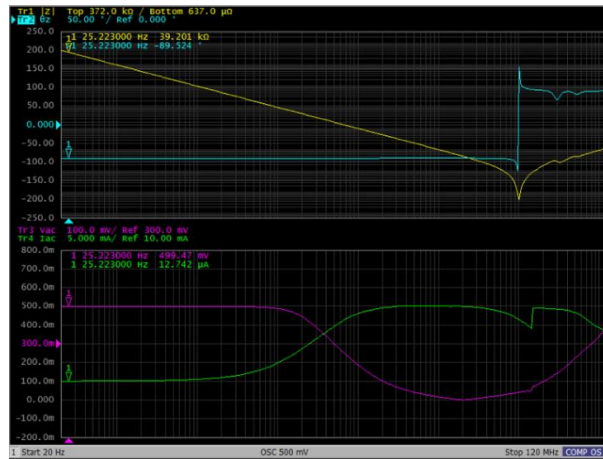
Ilustración 2. Análisis espectral del condensador de desacoplo
