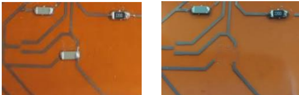
Figura 66: Componente soldado (izq) y detalle de daño al circuito impreso (der)
