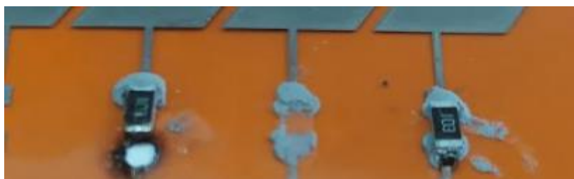
Figura 69: Daños en el sustrato a consecuencia de la soldadura por sinterizado láser
