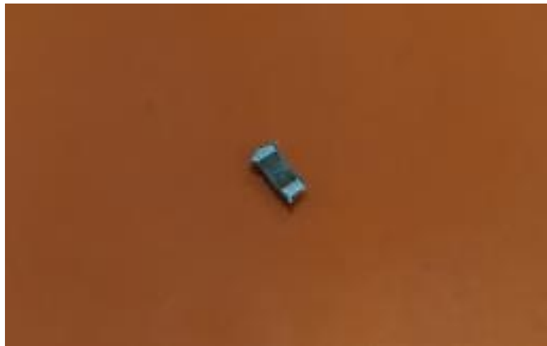
Figura 67: Vista inferior del condensador despegado con pista adherida al conector
