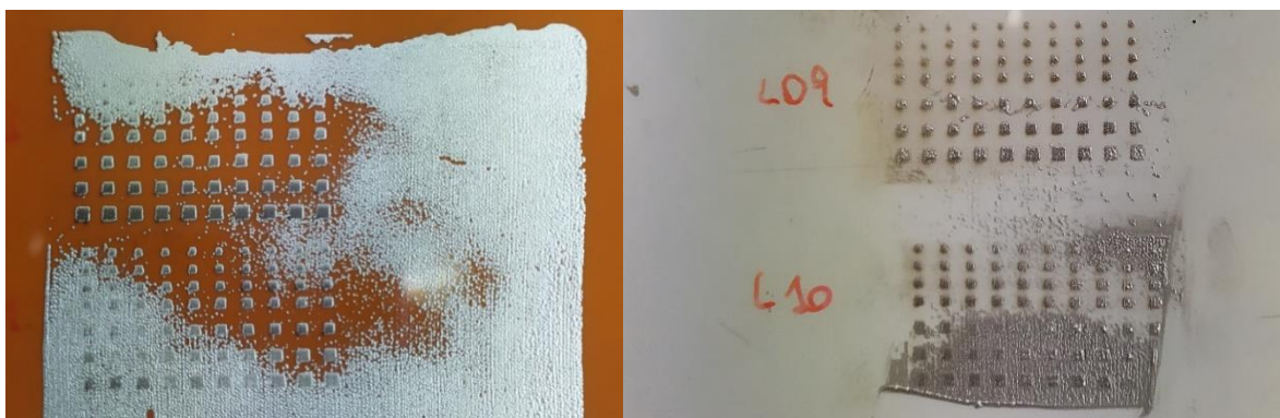
Figura 56: Puntos de soldadura impresos por láser en kapton (izq) y PET (der)
