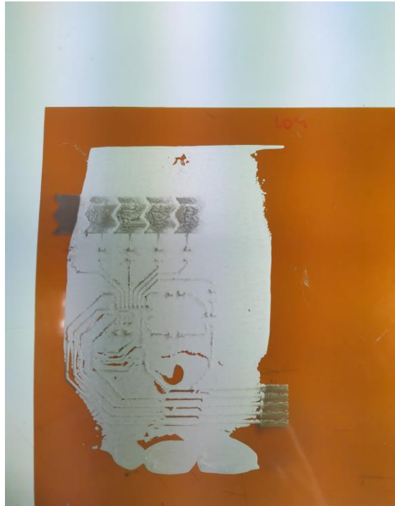
Figura 55: Prueba de impresión sobre Kapton defectuosa
