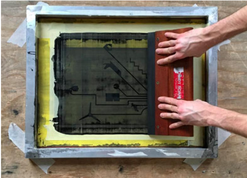
Figura 3: Proceso de impresión por serigrafía [3]
