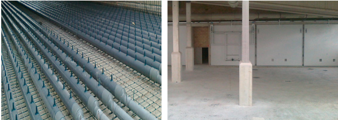
Figura 11: Sistema de túneles en planta de compostaje. (Planta de compostaje de lodos de Arazuri. RETEMA)
