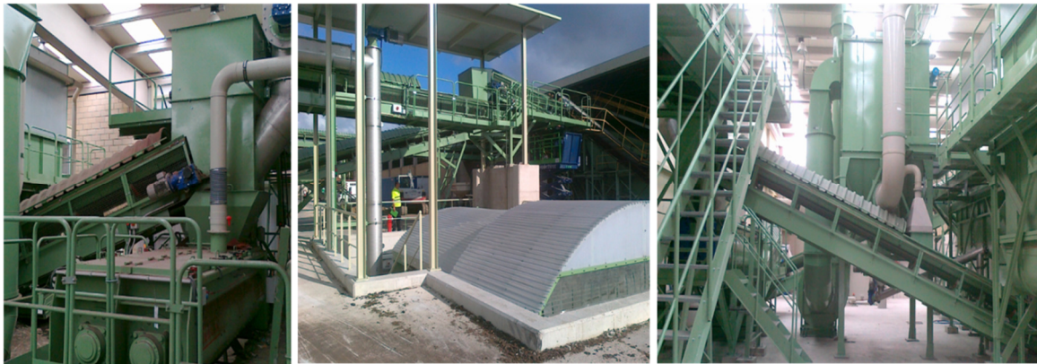
Figura 13: Sistema de cintas transportadoras y sinfines para tratamiento mecánico. (Planta de compostaje de lodos de Arazuri. RETEMA)
