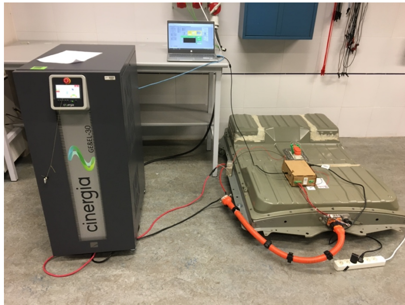
Figura 34: Banco de pruebas. Batería unida al Plug&Play, que se conecta al PC. El PC, a su vez, se comunica con Cinergia para que se apliquen las consignas de corriente.
