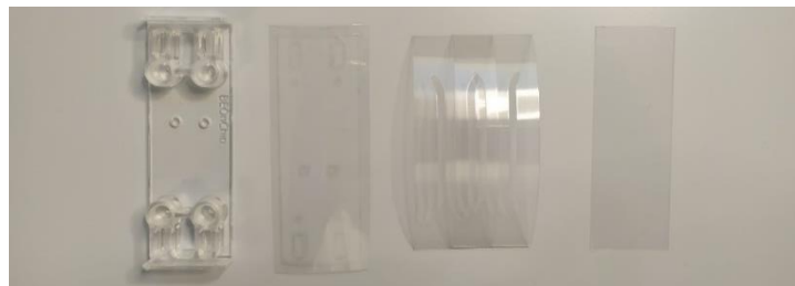
Fig. 4.28. Composición final del dispositivo diseñado. De izquierda a derecha: Pieza de inyección taladrada, Espaciador siliconado, Canales de COC híbrido y Base de COP.
