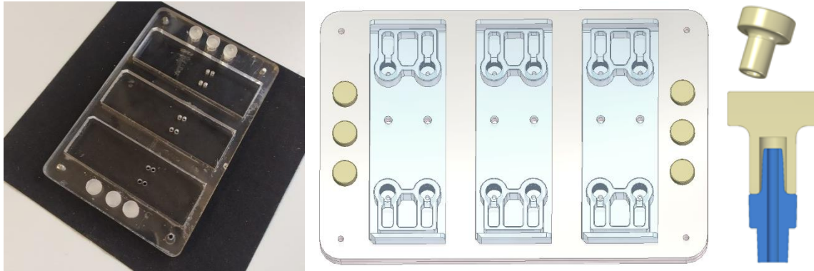
Fig. 4.21. Útil de liberación del Spot fabricado en PMMA (izq.); Modelo virtual del útil de liberación del Spot con las piezas de inyección y los aplicadores colocados en su lugar para proceder a introducir los SensorPlug (centro); Aplicador y su método de uso (drcha.).
