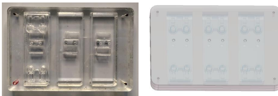
Fig. 4.18. Útil de taladrado fabricado en PMMA (izq.) y su modelo virtual con las piezas de inyección colocadas en su lugar y preparadas para ser taladradas (dcha.).
