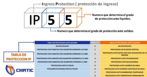
Figura 16: Grado de protección IP. Fuente: CMATIC
