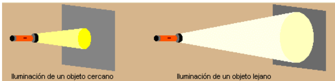
Figura 11: Concepto iluminancia. Fuente: Universitat Politecnica de Catalunya
