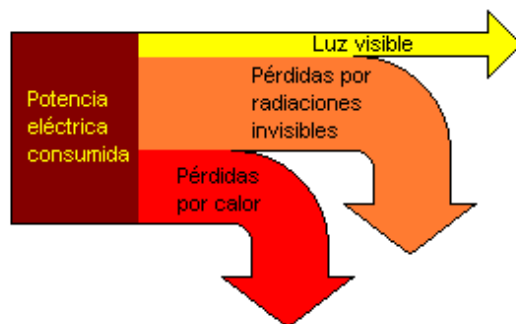
Figura 14: Diagrama rendimiento luminoso normal de una lámpara. Fuente: Javier García Fernández, Oriol Boix.
