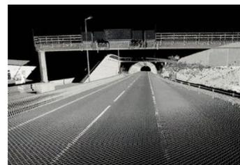
Figura 10. Nube de puntos captada mediante mobile mapping [fuente](#)
