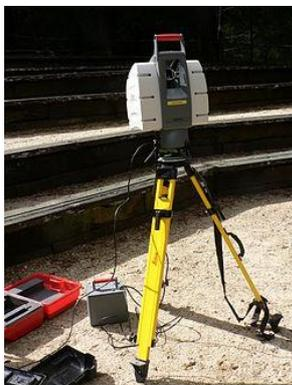
Figura 9. Lidar a nivel de suelo [fuente](#)
