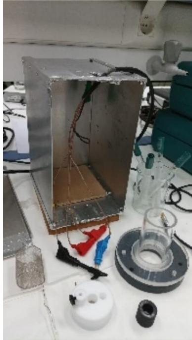
**Fig. 23.** Configuración instrumental adicional empleada para medir la resistencia a la corrosión.
