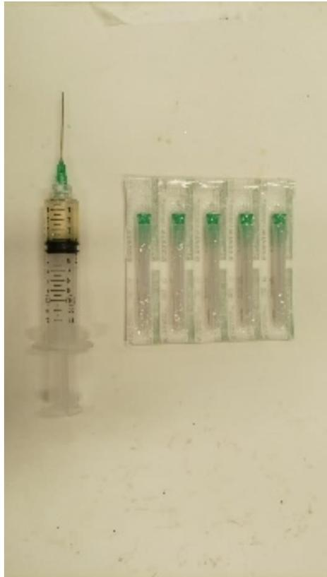
**Fig. 17.** Jeringa y aguja utilizada para la deposición de fibras.
