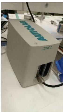
**Fig. 22.** Potenciostato/Galvanostato Autolab PGSTAT302N (Metrohm, Herisau, Suiza) utilizado en la experimentación.
