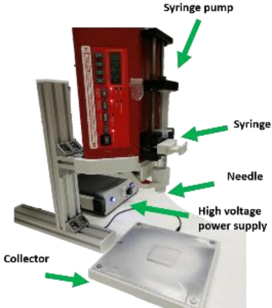
**Fig. 15.** Configuración instrumental utilizada para la deposición de fibras a través de la técnica de electrospinning.
