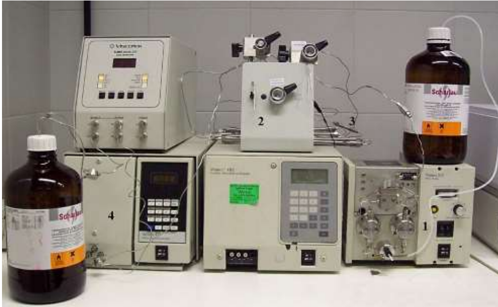
Figura 9. Equipo de cromatografía líquida por exclusión de tamaños (SEC): Bomba de alta presión (1); Inyector manual (2); Columnas cromatográficas (3); Detector de índice de refracción diferencial (4).
