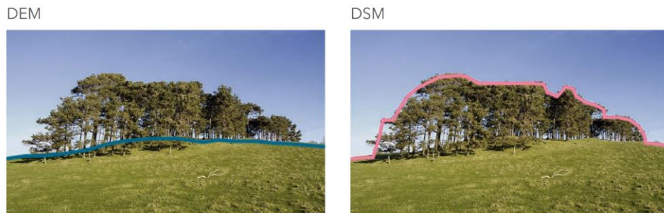
Figura 32. Diferencias entre DEM vs DSM. Fuente: (ESRI, 2021a)
