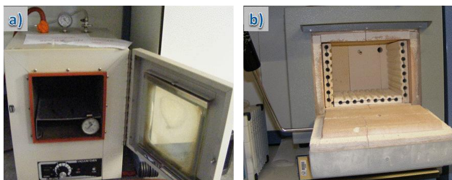
Figura 3.22 Hornos: a) de cámara de vacío y b) de mufla
