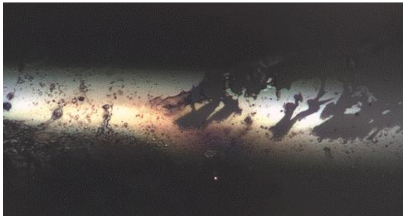
Figura 4.5. Deposición de \text{Fe}_3\text{O}_4 diluido en etanol sobre fibra óptica
