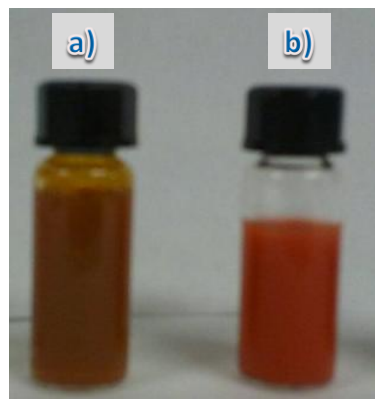
Figura 4.19. Disolución de partículas de \text{Fe}_2\text{O}_3 : a) sin tratar y b) tratadas térmicamente
