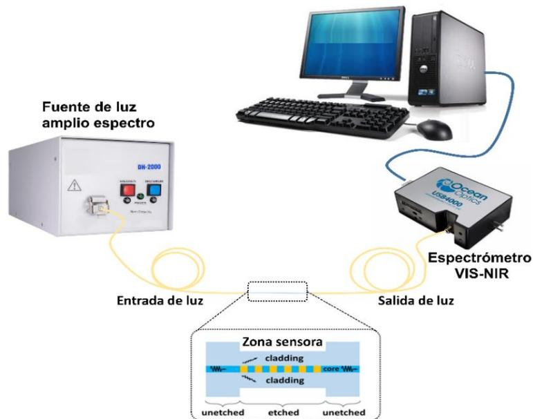
Fig. 3.2: Configuración experimental utilizada para realizar el etching y las mediciones.
