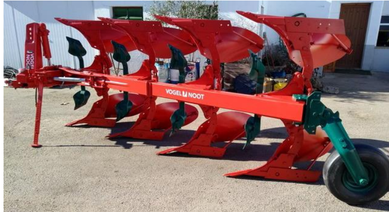
Figura 1: Arado de vertedera cuatririsurco. Fuente: https://agriocasion.com/
