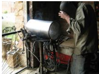
Soldado de los anillos al cilindro principal.
