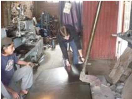
Cortado de la plancha con la guillotina.
