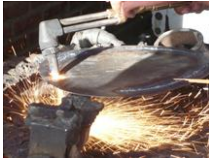
Corte de los anillos con oxicorte.
