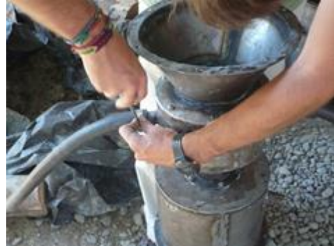
Fijado de la manguera de entrada de aire con abrazaderas.
