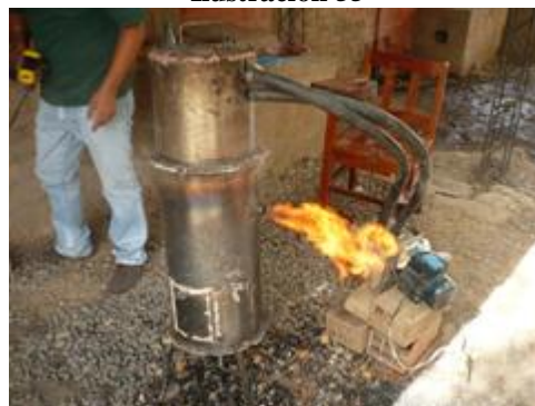
Gasificador modelo 2 funcionando.
