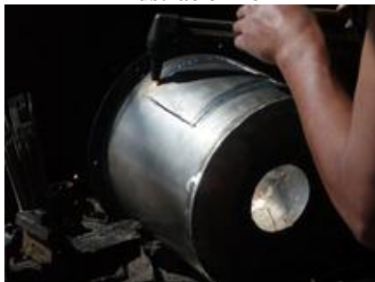
Corte de la puerta en cilindro de parrilla.
