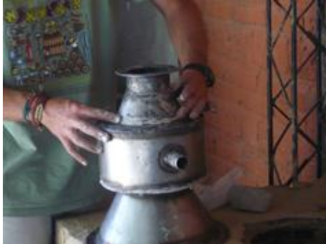
Sellado de juntas con arcilla.
