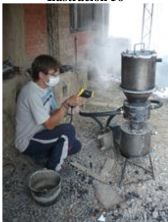
Toma de temperaturas con pistola infrarroja.
