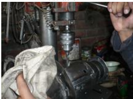
Taladrado de toberas en zona de combustión.
