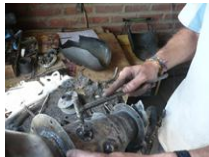
Retirada de material sobrante tras la soldadura de toberas.
