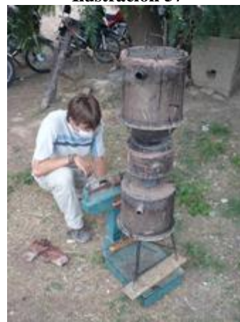
Pesado del gasificador al final de operaciones.
