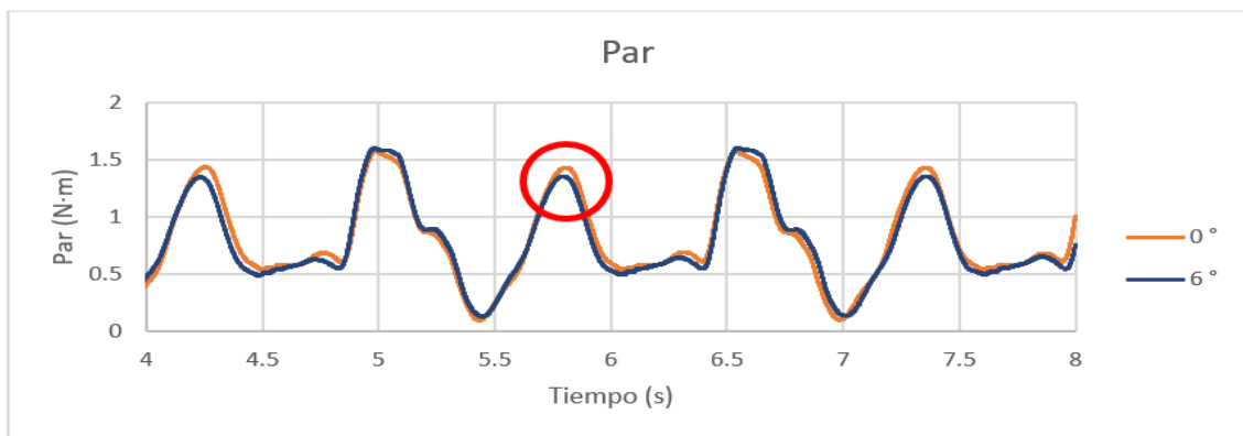
45. Fig. Comparación del par de los perfiles de 0° y 6°
