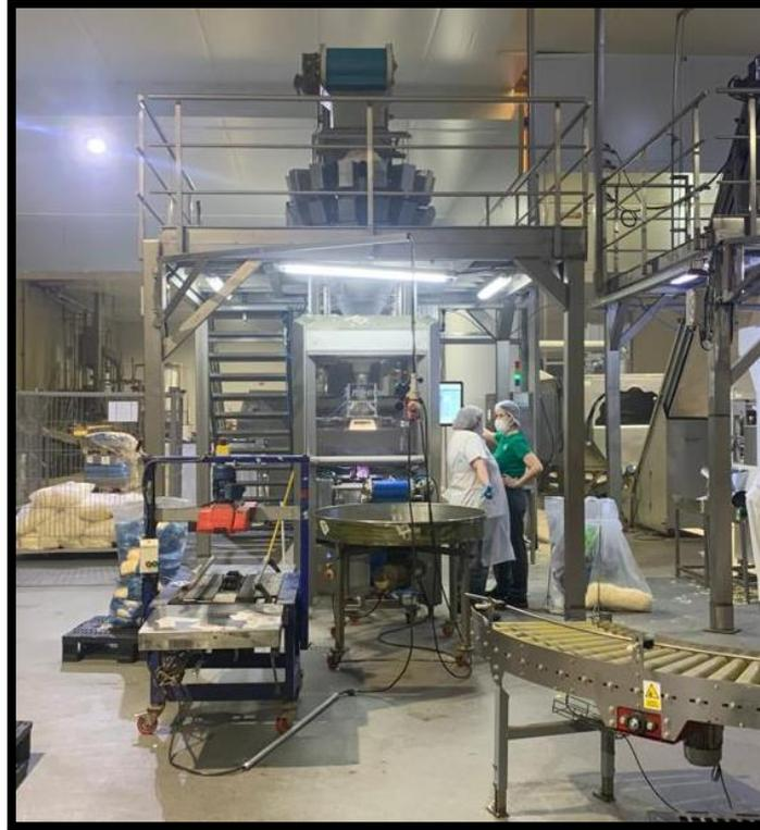
*Ilustración 12. Máquina envasadora de la marca Ishida*
