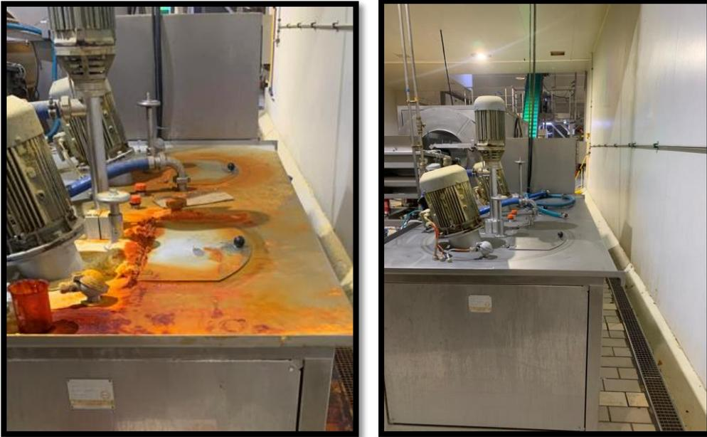
*Ilustración 31. Tanque de mezclas antes y después de la limpieza.*
