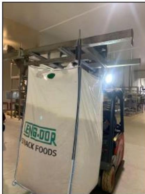
3. Proceder a la colocación de la saca sobre la estructura metálica.
