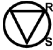
Ilustración 13. Símbolo de proceso crítico que afecta a la seguridad. Fuente: Documentación interna
