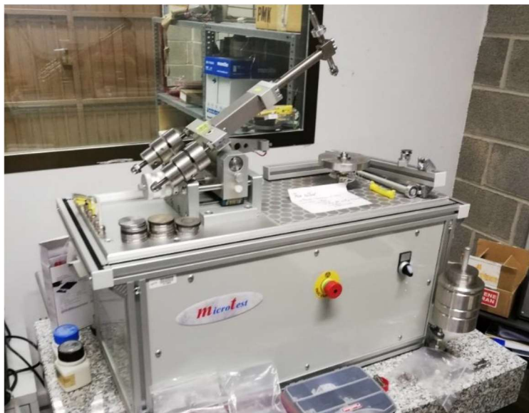
Ilustración 21: Tribómetro pin on disc MicroTest MT.
