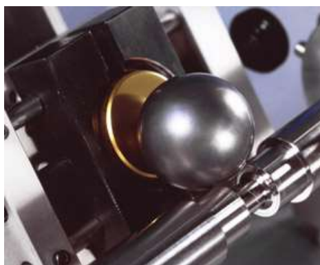
Ilustración 15: Bola de ensayo calotest junto a una muestra. Fuente: [24].
