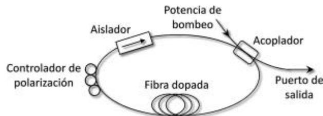
Ilustración 21: Esquema básico de un láser de cavidad en anillo [9]
