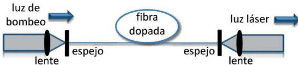
Ilustración 20: Esquema básico de un láser de cavidad lineal [9]
