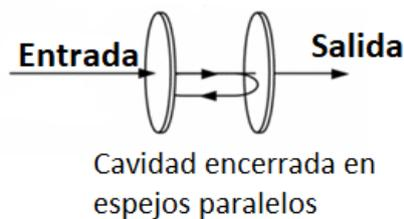
Ilustración 27: Funcionamiento de una cavidad Fabry-Perot [3]
