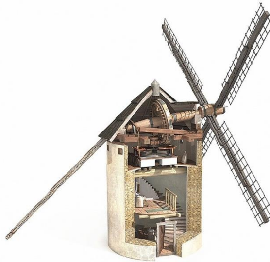
Figura 2: Molino de viento típico de La Mancha (izquierda). Representación seccionada del molino (derecha) [3] .
