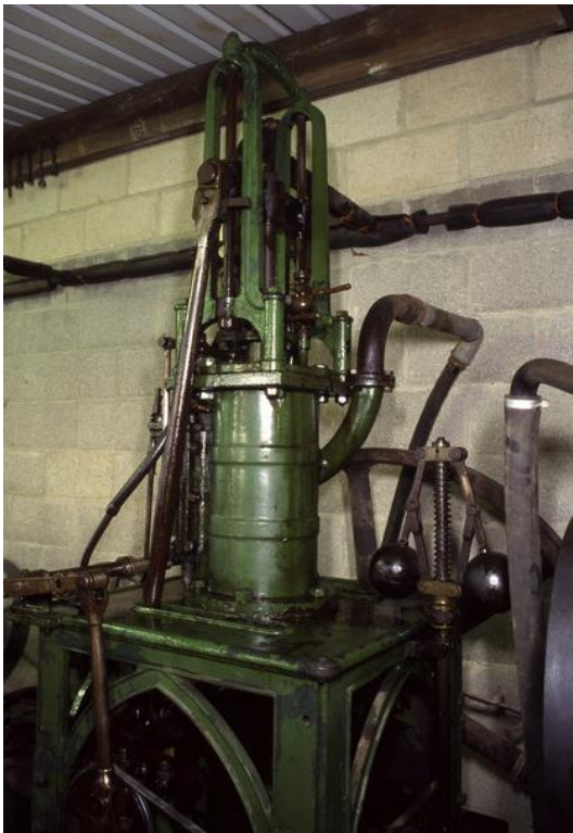
Figura 20: Máquinas de vapor de mesa (tienen la cruceta sobre el cilindro vertical y el cigüeñal debajo) [22].
