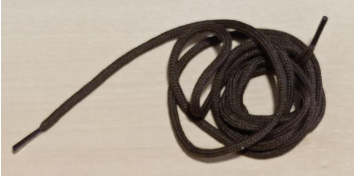
Figura 102: Cordón utilizado para simular las juntas de estanquidad.
