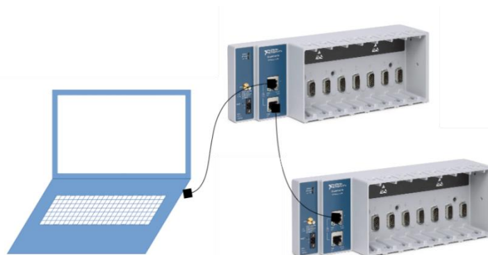
Figura 17 - Conexión de los cables Ethernet entre chasis
