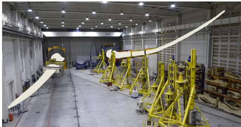
Figura 4 - Nave de ensayo de palas CENER [9]
