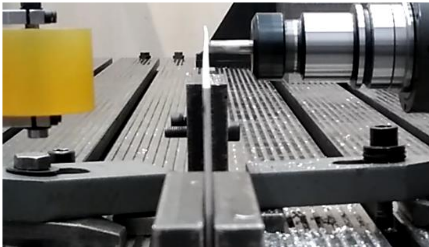
Ilustración 1. Pieza antes del mecanizado sin apoyo
