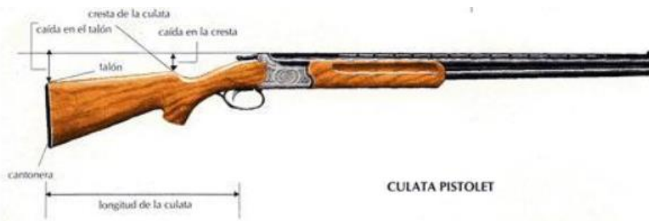
Ilustración 5 Partes de la culata [8]
