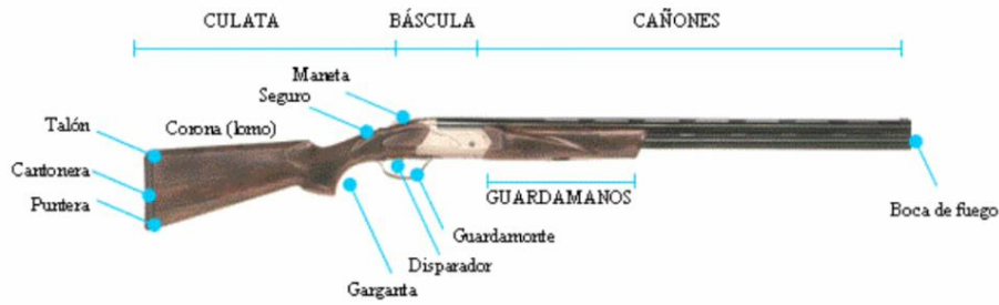
Ilustración 4 Partes de la escopeta [7]
