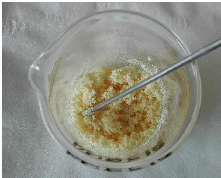
Figura 3. Soporte de alúmina impregnado con la disolución metálica.
