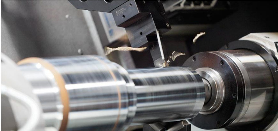
Figura 78. Torneado horizontal de un eje
