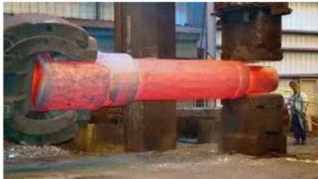
Figura 75. Forjado en caliente del eje principal de un aerogenerador de grandes dimensiones
