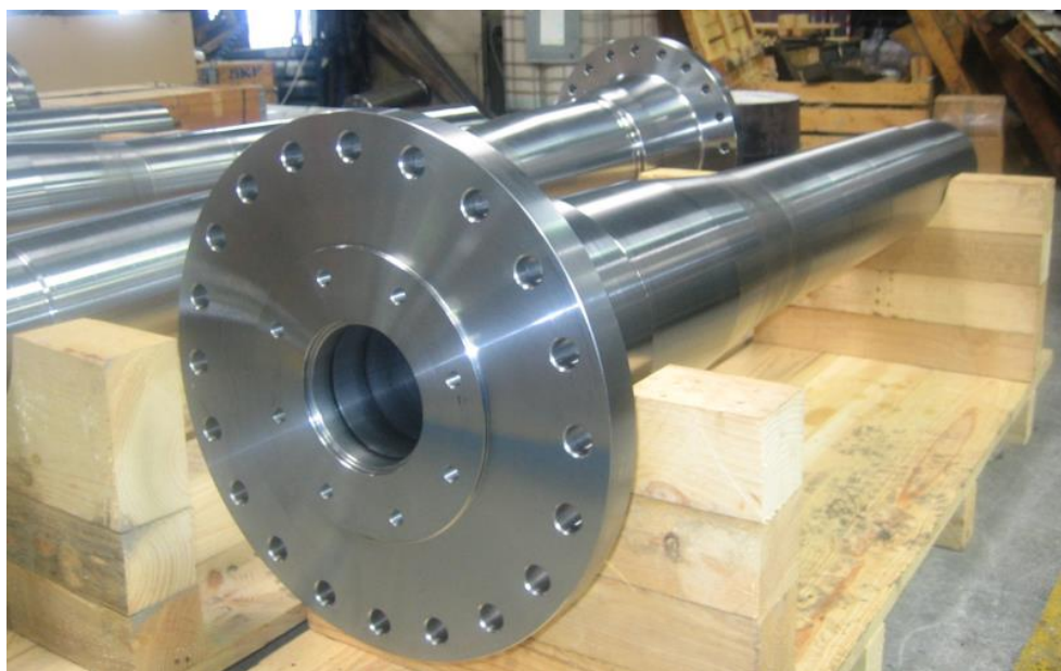
Figura 85. Eje principal de un aerogenerador tras los diferentes procesos de mecanizado
