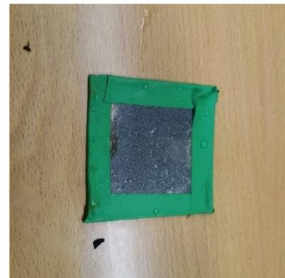
*Ilustración 39. 456 horas niebla salina, a) galvanizado, b) electrocincado, c) galvan, d) Magnelis®.*
