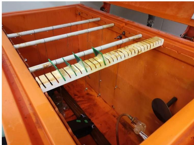
*Ilustración 19. Disposición de las muestras en la cámara.*
