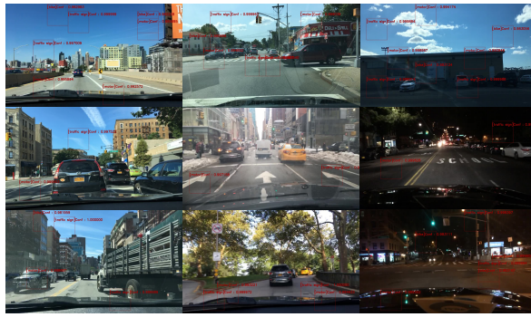
Figura 40: Otro ejemplo de falsos positivos en las detecciones del modelo con diferentes Bounding Boxes
