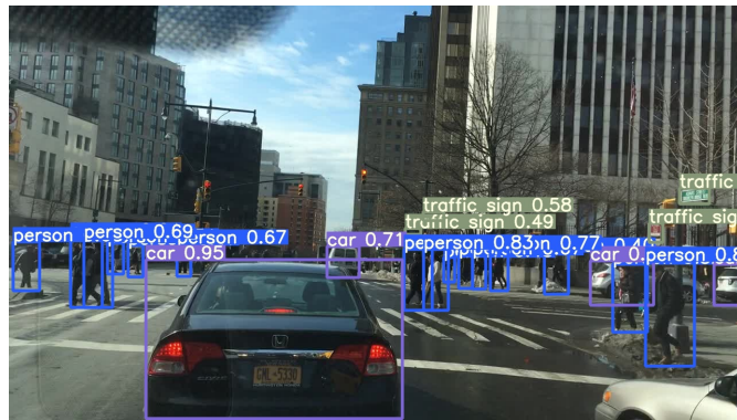
Figura 63: Ejemplo de detección precisa multiclase con YOLOv5
