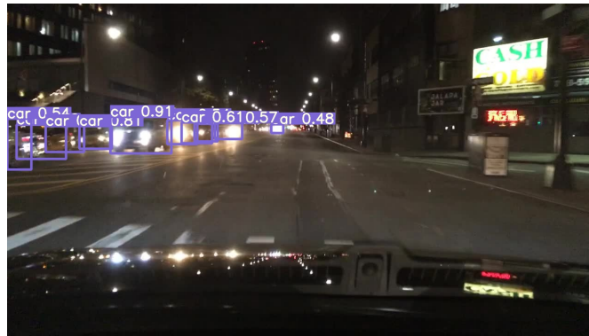
Figura 54: Ejemplo de no detección de señales de tráfico pese a su semejanza (carteles de la derecha) de YOLOv5
