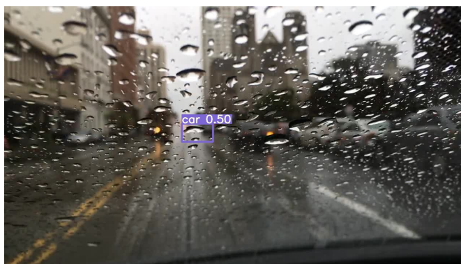
Figura 61: Ejemplo de detección errónea de un coche en un cristal mojado con YOLOv5
