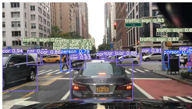
Figura 65: Ejemplo de detección precisa multiclase con YOLOv5
