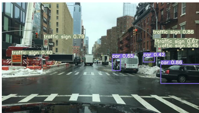
Figura 60: Ejemplo de detección errónea de un coche (parte derecha de la imagen) con YOLOv5
