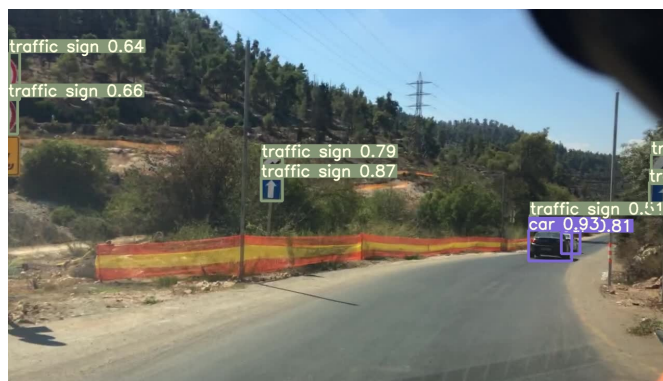
Figura 56: Ejemplo de detección de señal de tráfico pese a la poca visibilidad (señales de la izquierda) de YOLOv5
