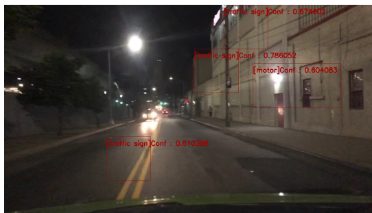
Figura 42: Ejemplo de coincidencia parcial de señal de tráfico a la derecha de la imagen
