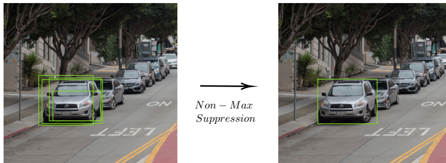
Figura 18: Ejemplo de Supresión de No Máximos
