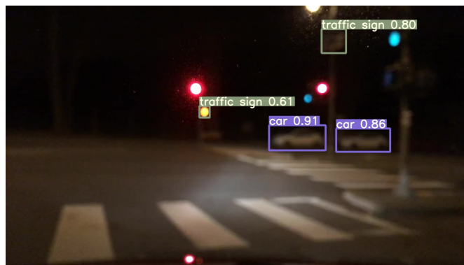
Figura 57: Ejemplo de detección de dos señales (un falso positivo) y dos coches pese a la borrosidad de la imagen con YOLOv5
