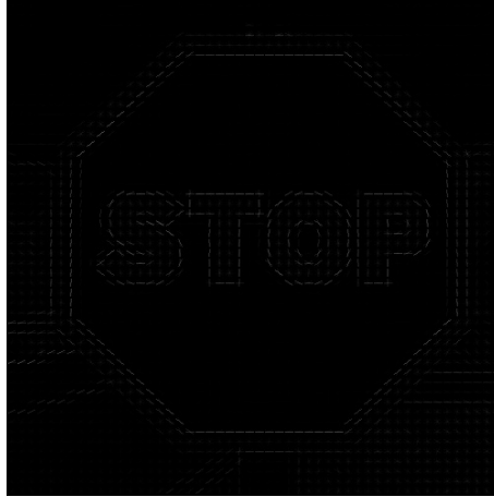
Figura 16: Ejemplo de HOG aplicado a una imagen de Señal de Stop
