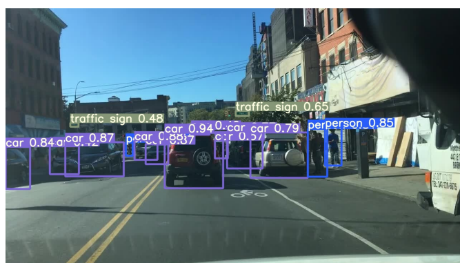
Figura 53: Ejemplo de resultados con el cielo despejado de YOLOv5
