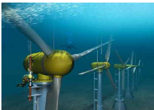
Ilustración 3. Turbinas hidrocineéticas de flujo axial con estructura abierta.
