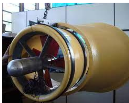
Ilustración 4. Turbina hidrocineética de flujo axial con estructura cerrada.
