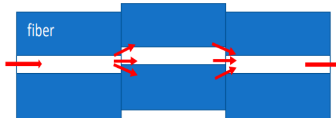
Figura 8: ESTRUCTURA DE UN SENSOR SMS CON 2 CO - FUENTE: [12]
