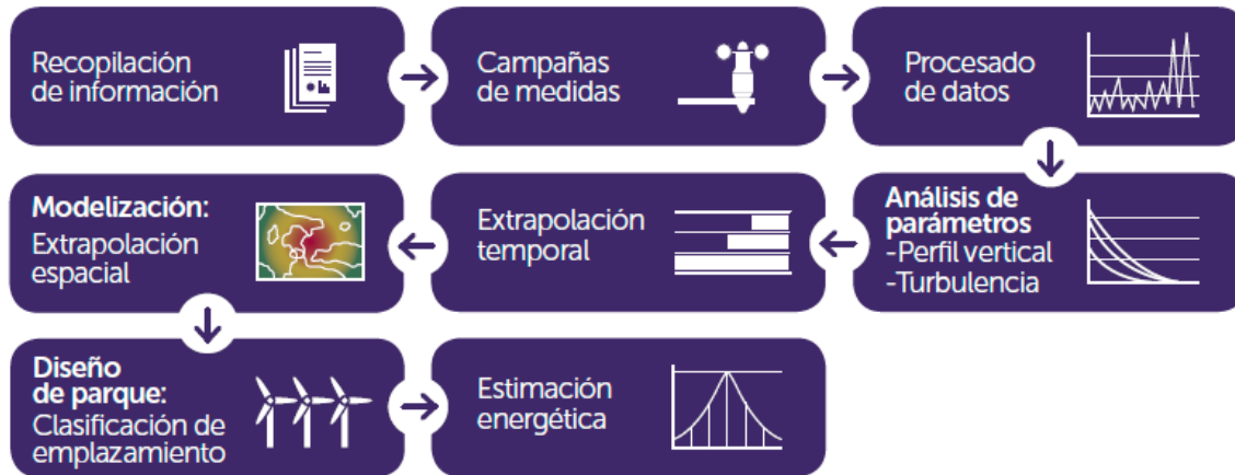
Figura 3 Esquema de las fases de un estudio de evaluación de recurso eólico y estimación de energía.
