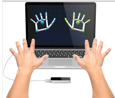
Figura 3: Ejemplo del funcionamiento de Leap Motion [14].
