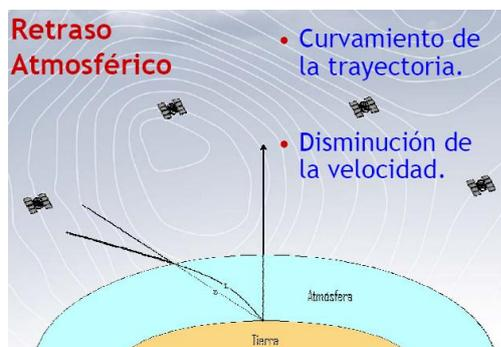
Figura 11 Ejemplos del retraso atmosférico que sufre la señal GPS
