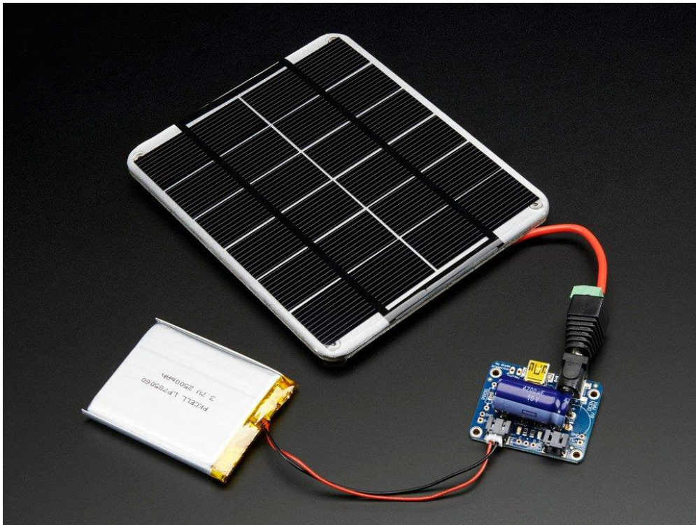
Figura 6 - Montaje del cargador Adafruit 390
