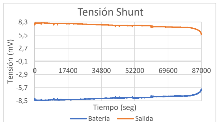
Gráfica 18 - Tensión Shunt en la prueba de descarga de la placa desarrollada
