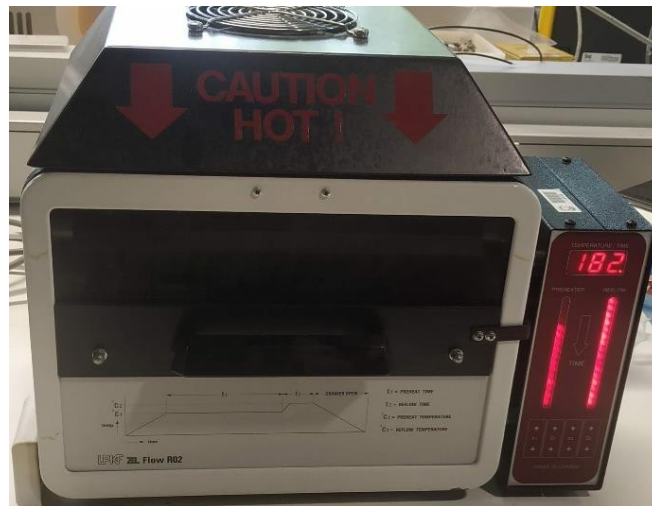
Figura 24 - Horno de soldadura
