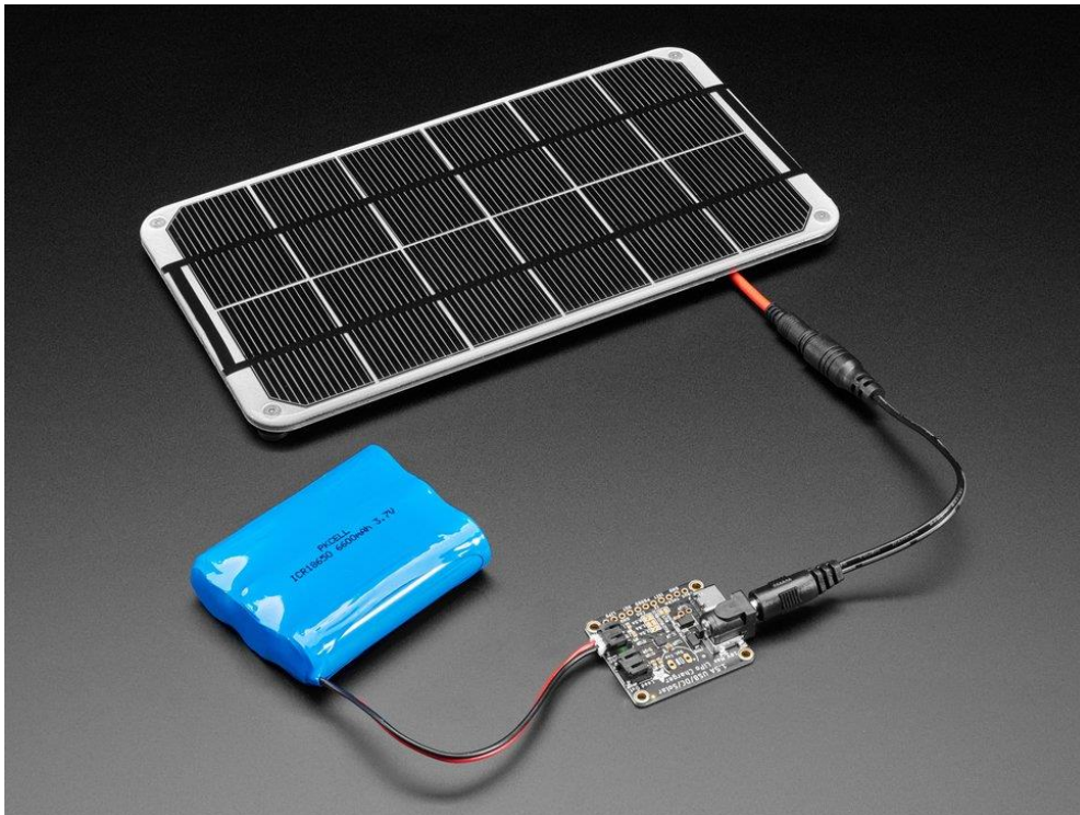
Figura 7 - Montaje del cargador Adafruit 4755
