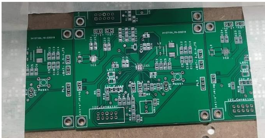
Figura 29 - Sujeción de PCB
