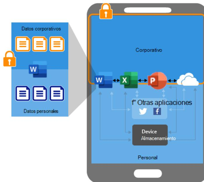
**Figura 65.** Aplicaciones con directivas de protección de aplicaciones en dispositivos. [54]
