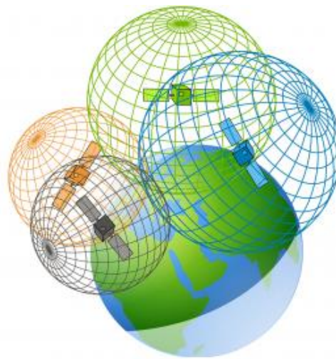
Figura 3. Trilateración de cuatro satélites en sistema tridimensional. [3]
