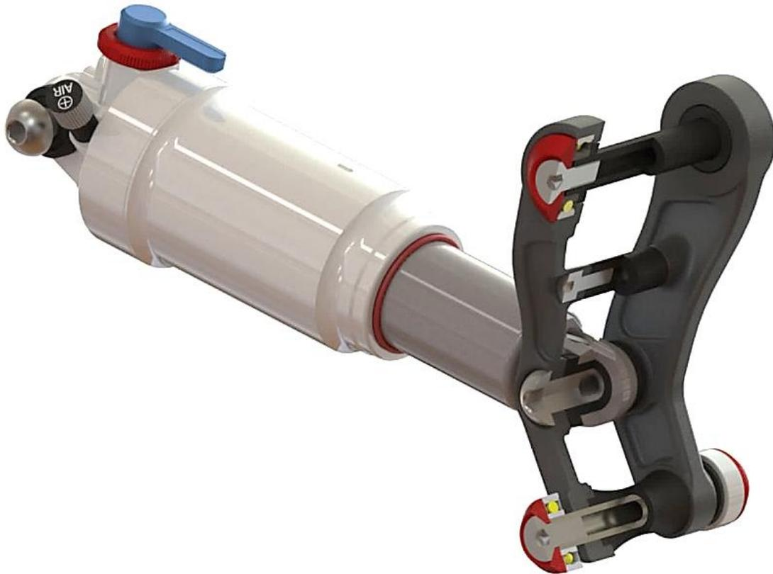
Imagen 29. Renderizado 3D del sistema original modelizado mediante medición manual
