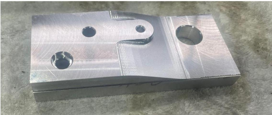
*Imagen 111. Estado de la pieza tras el mecanizado de la primera atada*
