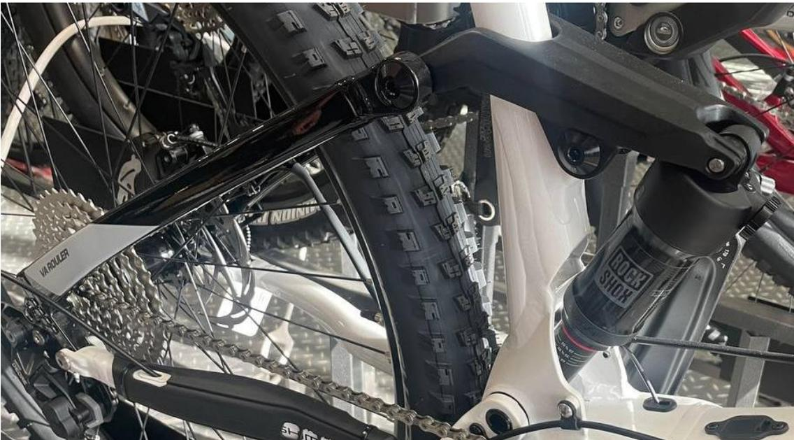
*Imagen 14. Detalle del sistema de suspensión trasera de la Sunn Gordon S2*
