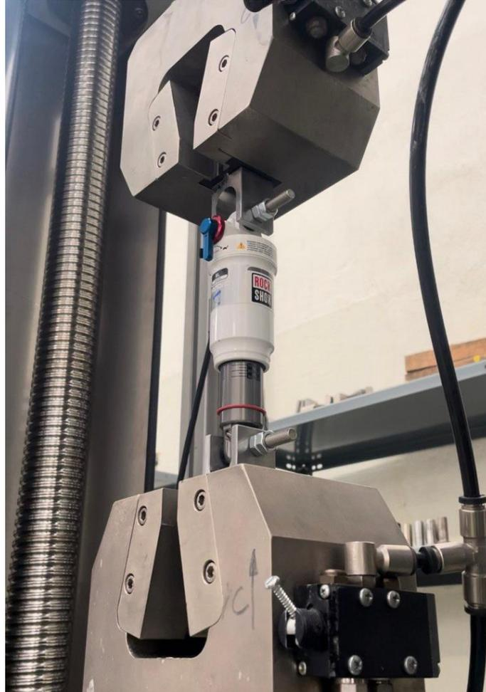
Imagen 36. Fotografía realizada durante el ensayo del amortiguador
