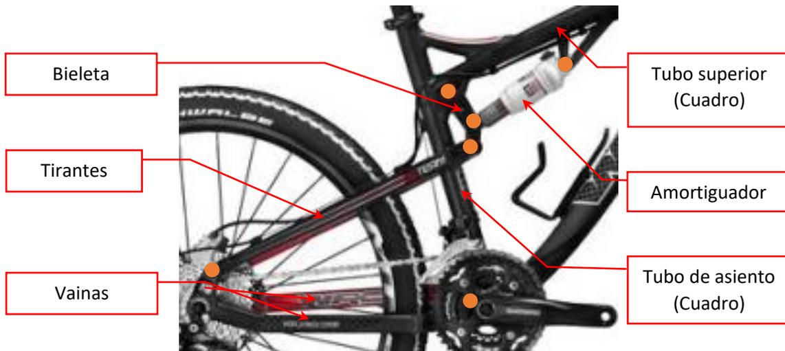
Imagen 2. Detalle sistema de suspensión trasera [2]
