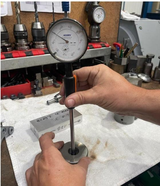
Imagen 112. Calibración del alexómetro
