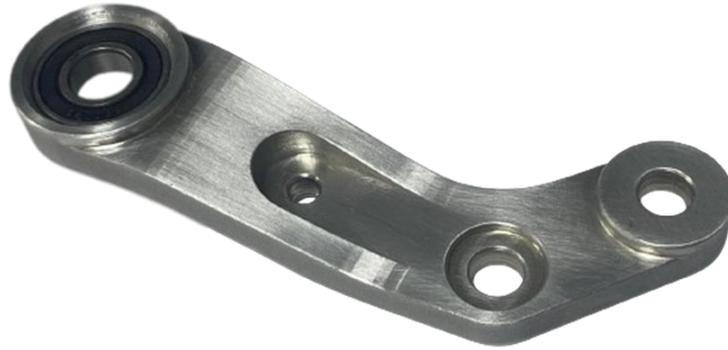
*Imagen 126. Bieleta izquierda finalizada con rodamiento montado*
