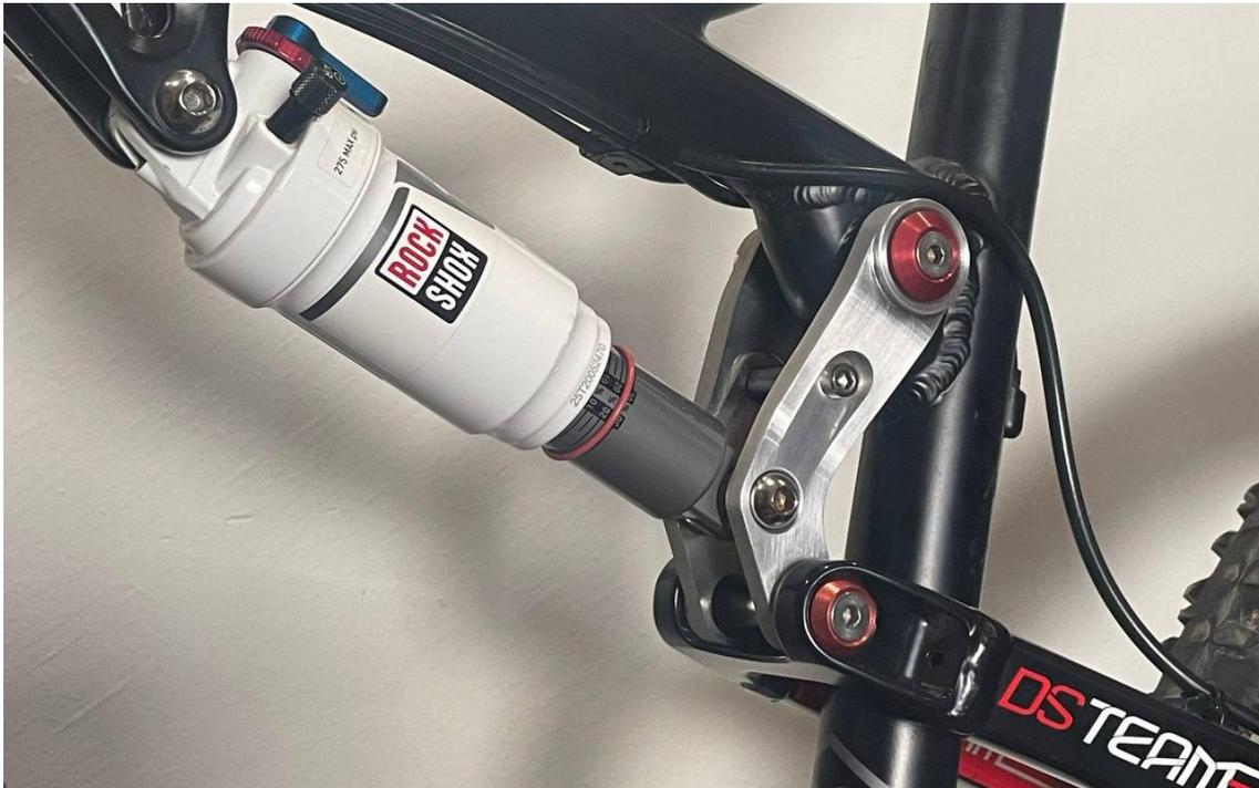
*Imagen 129. Nuevo sistema de bieletas montado en la bicicleta*
