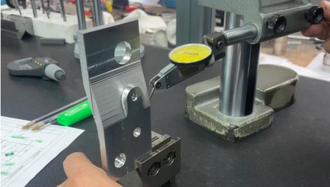
Imagen 117. Alineación de la pieza sobre la base
