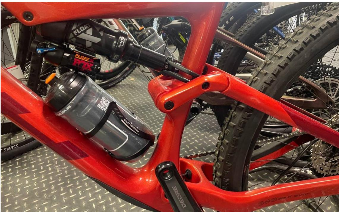
Imagen 10. Detalle del sistema de suspensión trasera de la BH Lynx Trail
