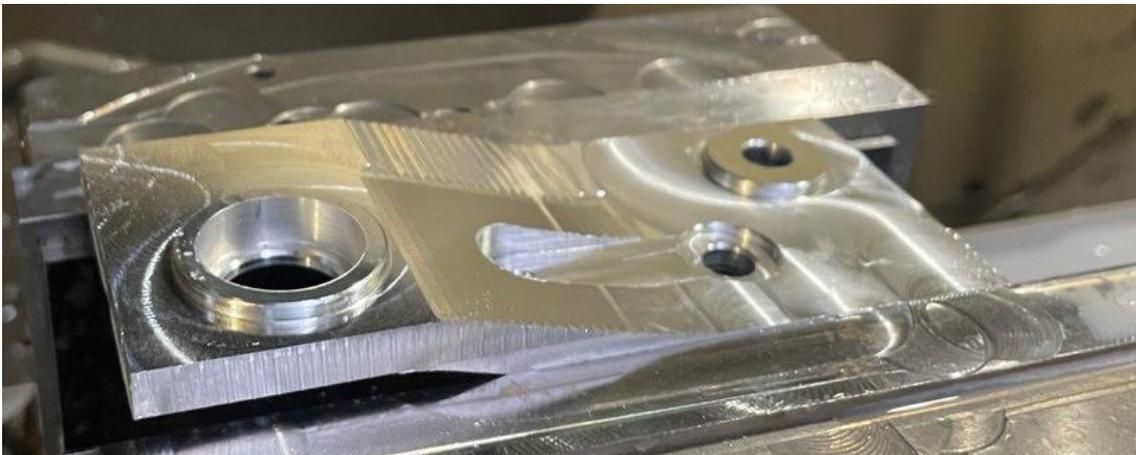
Imagen 114. Resultado tras el mecanizado de la segunda atada
