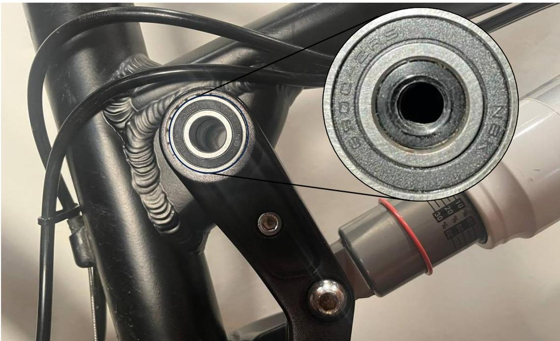
Imagen 26. Identificación del rodamiento de la bieleta
