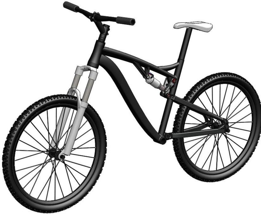
Imagen 31. Imagen tridimensional del modelo 3D de la bicicleta
