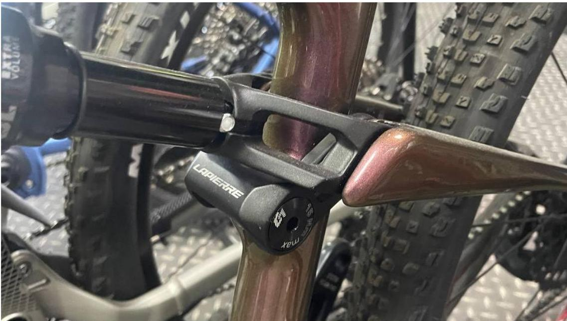
Imagen 12. Detalle del sistema de suspensión trasera de la Lapierre
